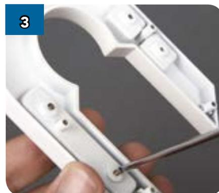
Переверните собранную конструкцию и через соответствующие отверстия закрепите стабилизатор двумя серебряными шурупами. Закрутите их так, чтобы стабилизатор был надёжно зафиксирован.
