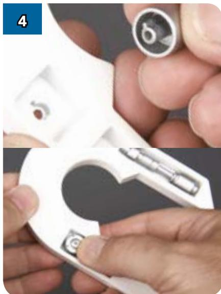
Возьмите один из смазочных фитингов (LPR-02) и вставьте его в верхнее углубление детали (LPR-08), убедившись, что выступ с обратной стороны детали (LPR-02) правильно вошёл в предназначенное для него гнездо.
