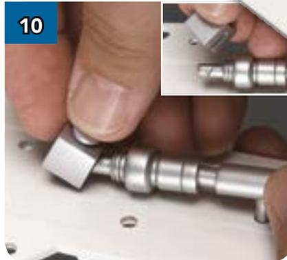
Быстросохнущим клеем смажьте конец детали (LPR-05) и вставьте его в деталь (LPR-03), как показано на фотографии 10. Удерживайте обе детали в нужном положении до полного высыхания клея.
